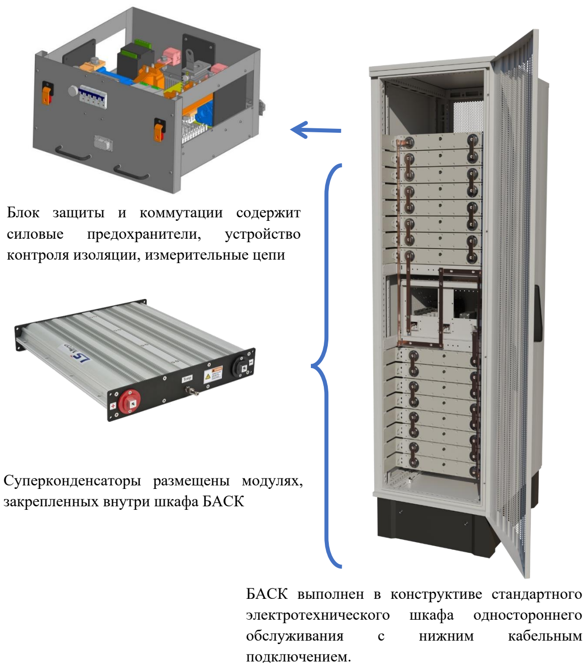
Рисунок 8 – Конструкция шкафа БАСК
